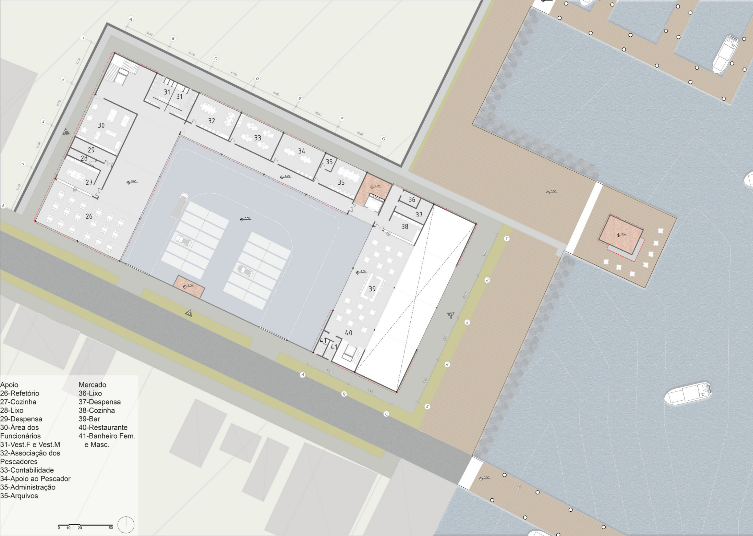
Figura 5.10 - Planta Primeiro Pavimento na escala 1.200. Fonte: Autoria própria.
